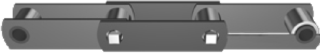
Рисунок В1 - Цепь тяговая пластинчатая по ГОСТ 589-85
