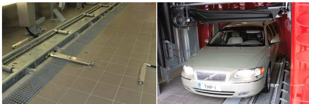
Рисунок 2.4- Конвейер туннельной автомойки Tammermatic Robojet
