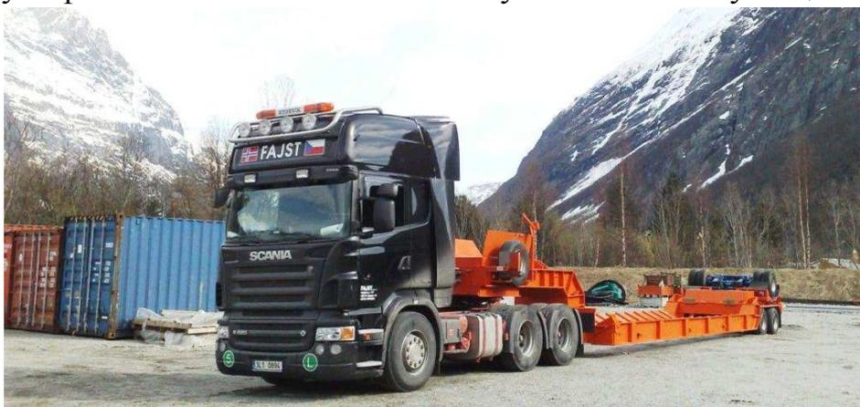
Рисунок 2.3 – Комплект транспортных средств для перевозки крупногабаритного груза
