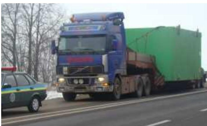
Рисунок 1.2 - Перевозка крупногабаритного тяжеловесного груза
