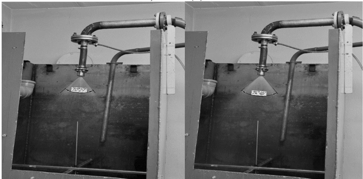
**Рис. 4. Угол конуса распыла для форсунки ФЦ при давлении 0,05 МПа (А) и 0,25 МПа (Б)**
