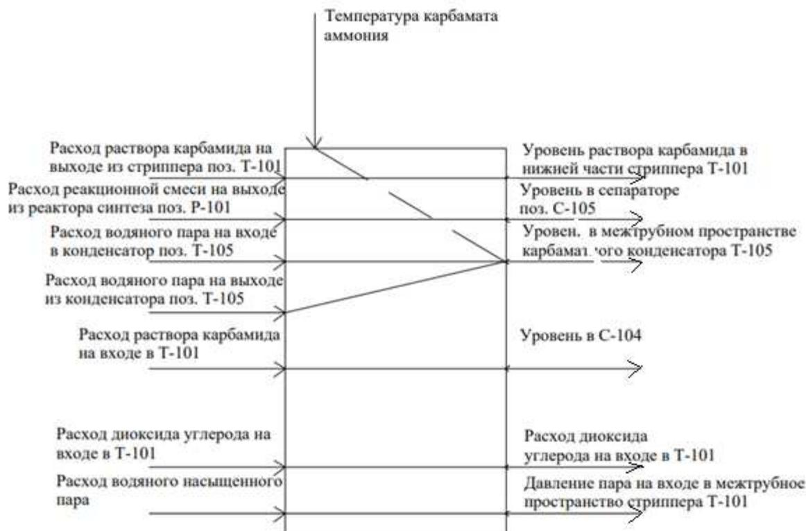
Рис. Информационная схема объекта управления
