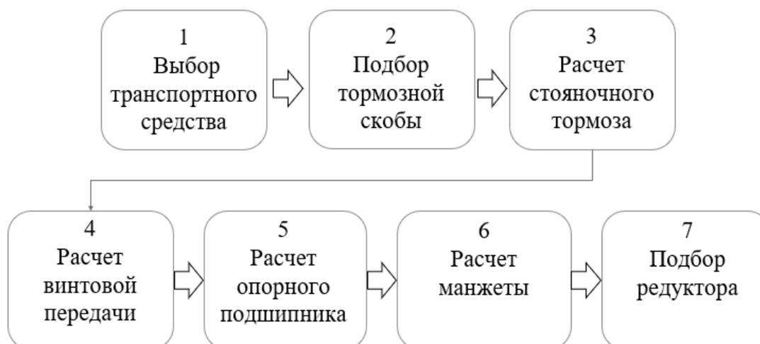
**Рис. 1. Схема методики проектирования электромеханического стояночного тормоза**
