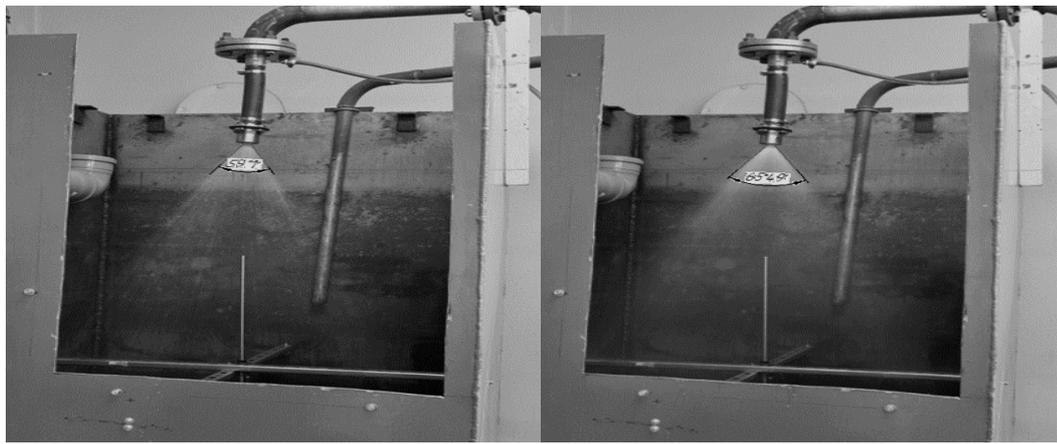
**Рис. 2. Угол конуса распыла для форсунки ФПТМ при давлении 0,05 МПа (А) и 0,25 МПа (Б)**
